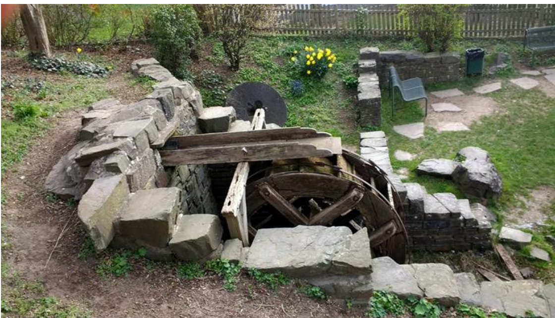
Wasserrad im Weierohl, über den oberen Zulauf wird das Wasser auf das Rad geleitet
